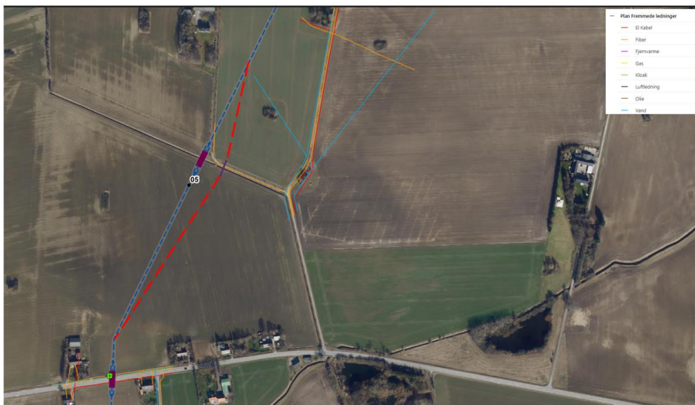
Figur 5-16 Oversigtsfoto omkring HDD 12. Den stiplede mørkeblå linje viser det oprindelige kabeltracé mens den røde stiplede linje giver et forslag til kabeltracé, hvor underboringen udføres således den krydser den nærliggende vej og et fiberkabel.
